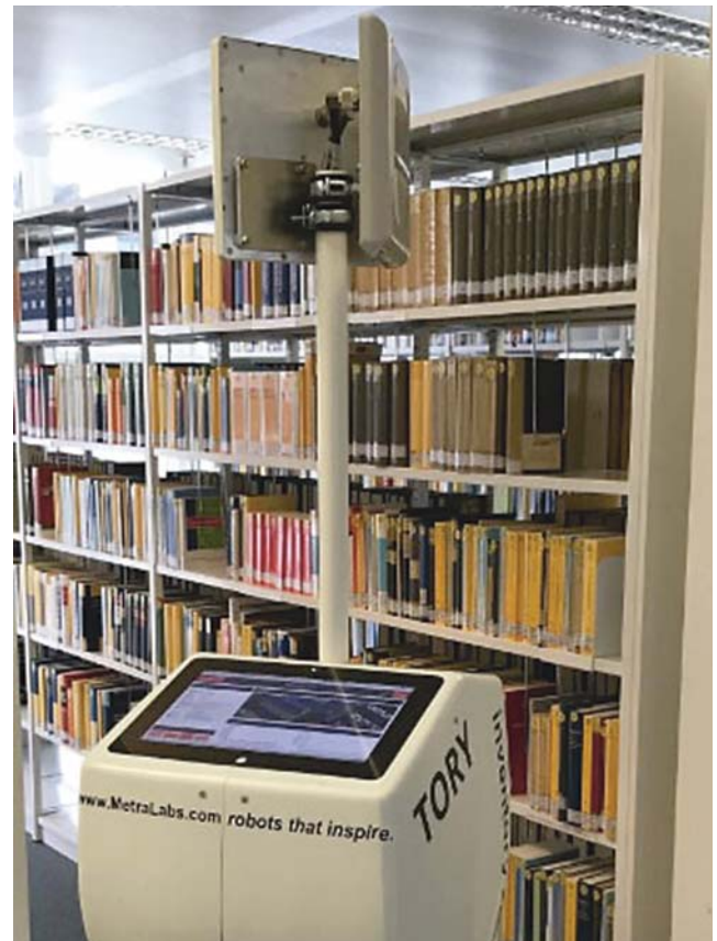
Der Inventur-Roboter Tory im Einsatz in der Bibliothek des Max-Planck-Instituts in Luxemburg. Bei einem Testlauf im Oktober 2016 arbeitete der Roboter mit einer Erfassungsgenauigkeit von mehr als 99 Prozent. Fotos: Max-Planck-Institut Luxemburg
