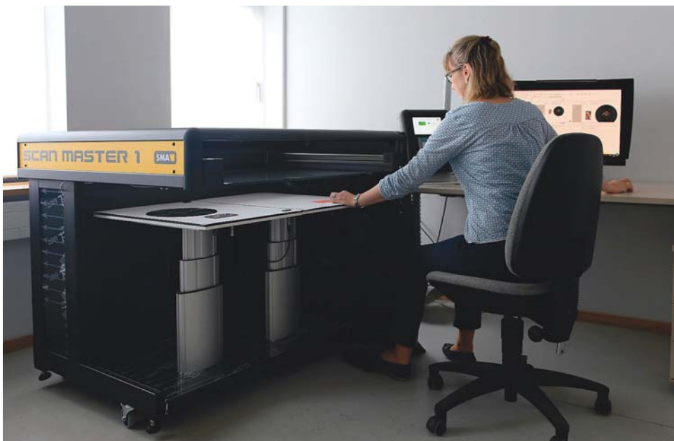
Durch die Kombination mit einem motorisierten Arbeitstisch konnte ein auf den Anwender bezogener, anpassungsfähiger Arbeitsplatz erstellt werden.
