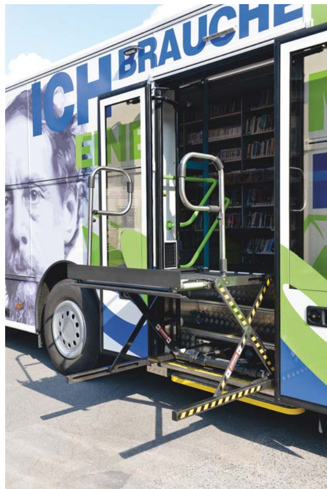
Der Rollstuhllift lässt sich innerhalb von 30 Sekunden ein- und ausfahren und wird vom Personal auch zum Ein- und Ausladen der Transitmedien genutzt.
