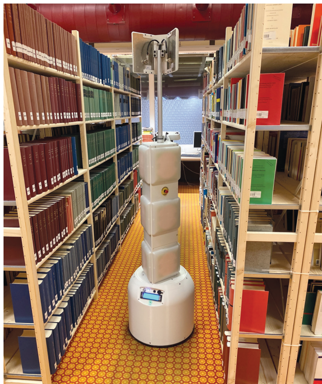
Tory bei der Arbeit zwischen den Holzregalen. Bei den rechteckigen Kacheln handelt es sich um die RFID-Antennen.
