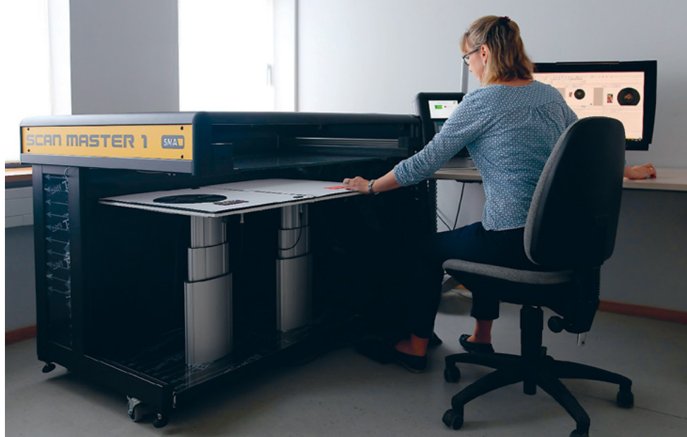
Durch die Kombination mit einem motorisierten Arbeitstisch konnte ein auf den Anwender bezogener, anpassungsfähiger Arbeitsplatz erstellt werden.
