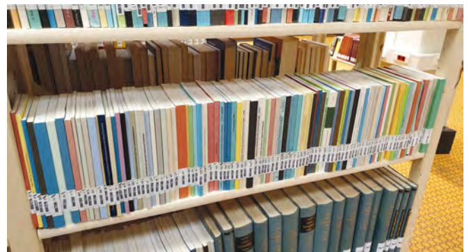
Eine absichtlich konzentrierte Menge dünner Bände. Die Erkennungsgenauigkeit ist bei den verwendeten RFID-Tags tatsächlich nicht von der Buchdicke abhängig.
